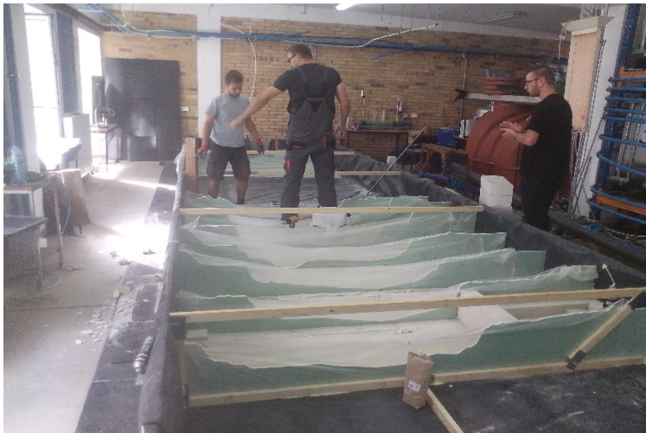
Rys. 2. Studenci kierunku IGW w trakcie budowy modelu rzeki Niemen w Laboratorium wodnym Katedry Inżynierii Wodnej i Sanitarnej.
