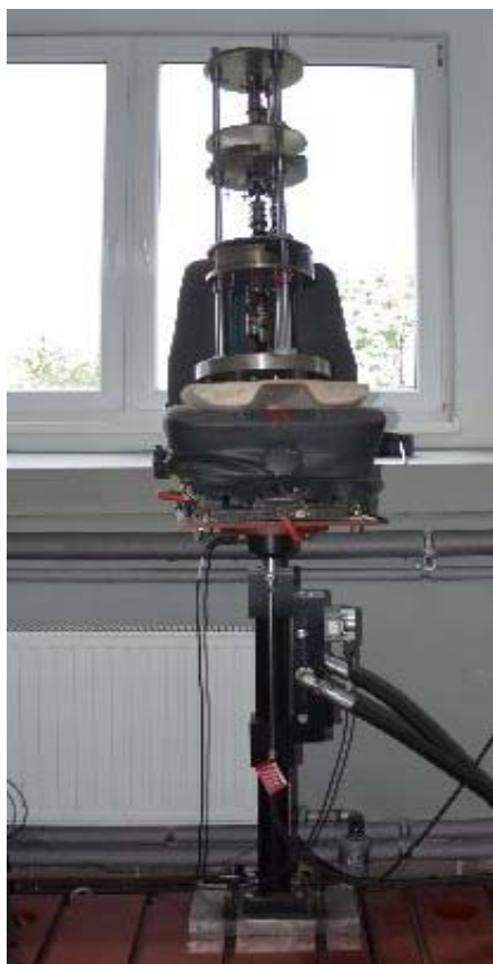
Rys. 4. Widok pulsatora elektrohydraulicznego wraz z układem fotel samochodowy – manekin antropodynamiczny.
