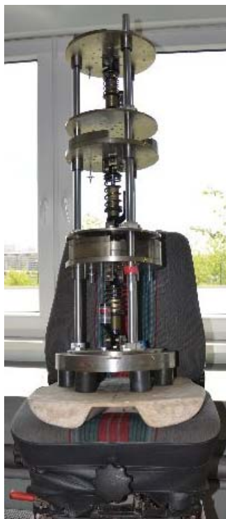
Rys. 2. Widok układu fotel - manekin antropodynamiczny.
