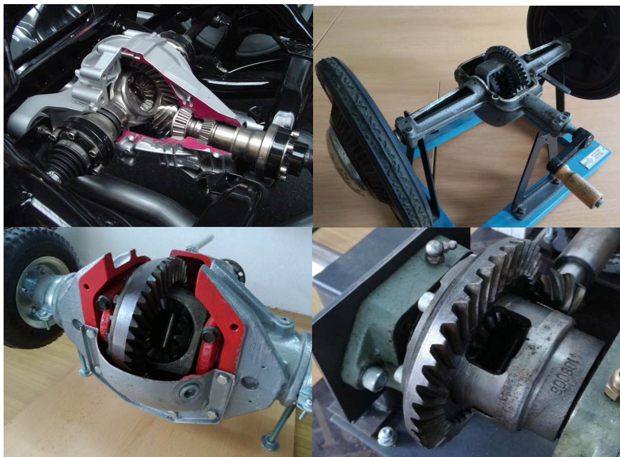
Rys. 1. Przykłady modeli klasycznego układu napędowego, w których wykorzystano stożkowy mechanizm różnicowy [2, 3, 4].
