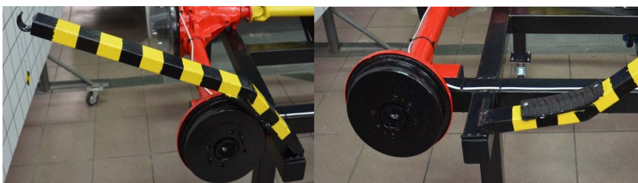
Rys. 5. Wyjściowe pozycje dźwigni hamulcowej.
