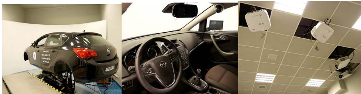
Rys. 1. Symulator samochodu osobowego AS1200-6 [fot. ITS].
