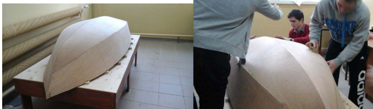
Rys. 10. Gotowy kadłub jachtu wykonany ze sklejk.
