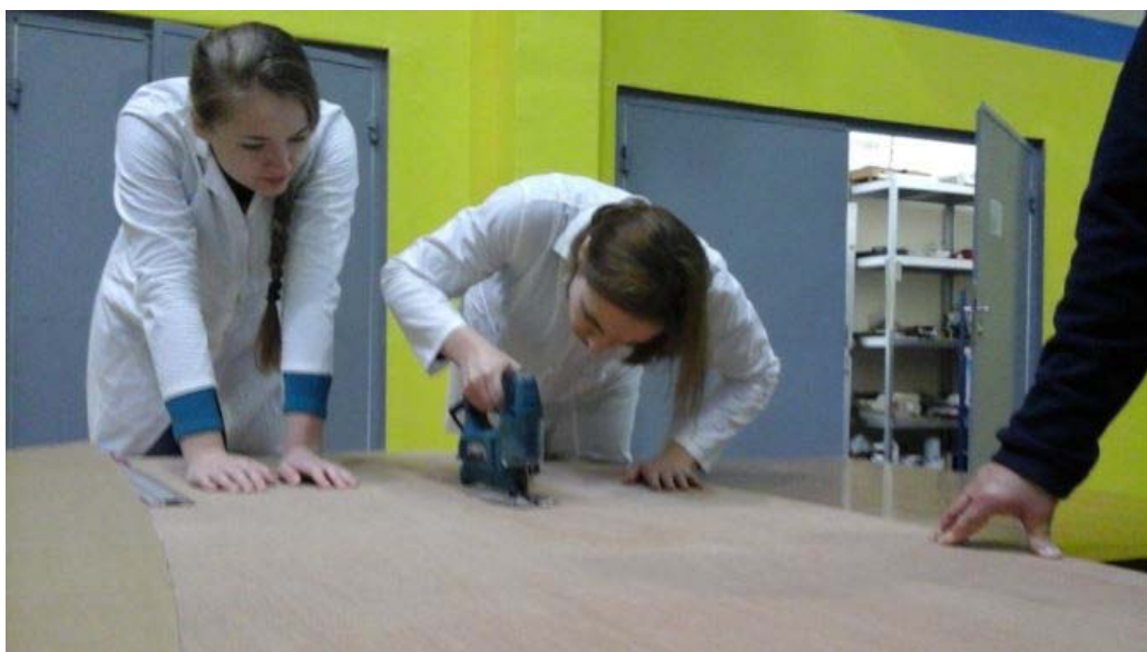
Rys.. 8. Wycinanie poszycia dna i burt ze sklejk.
