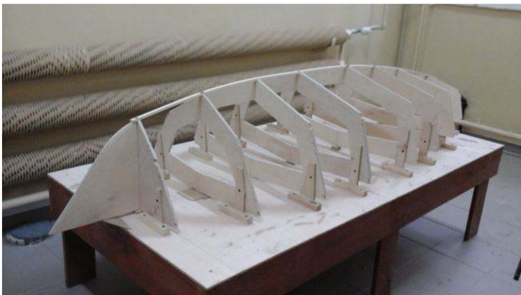
Rys. 5. Łączenie wrgów listwami burtowymi i stępką.
