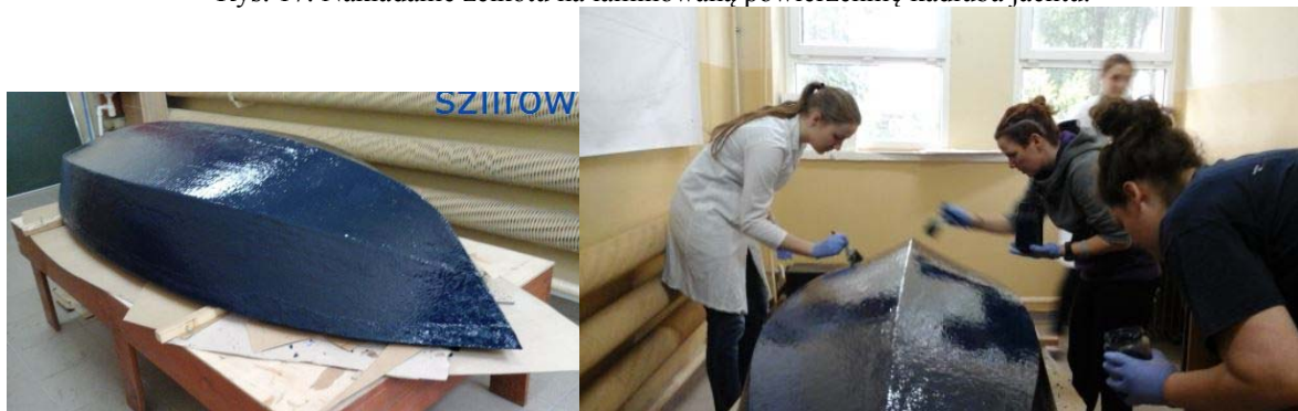
Rys. 18. Kadłub z warstwą żelkotu, szlifowanie żelkotu.
