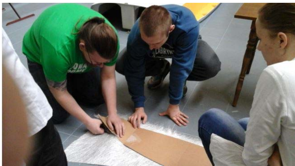
Rys. 14. Przycinanie maty szklanej do laminowania dna.
