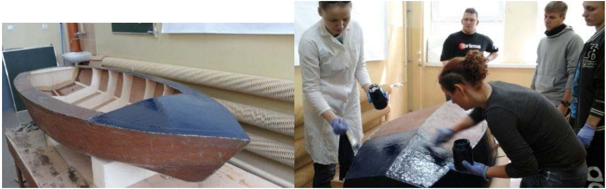
Rys. 17. Nakładanie żelkotu na laminowaną powierzchnię kadłuba jachtu.
