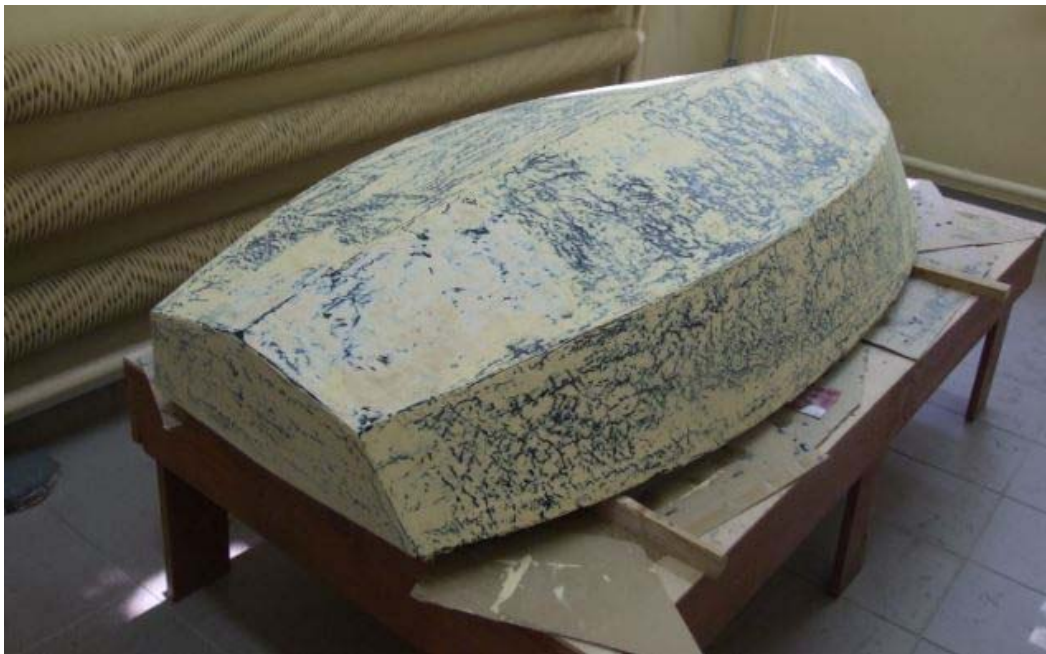
Rys. 19. Kadłub jachtu z nałożoną szpachlówką.
