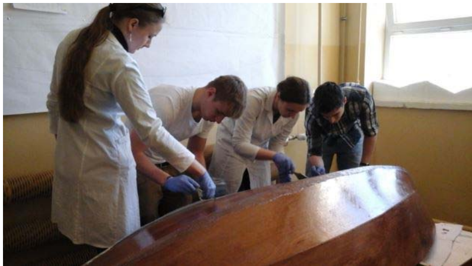
Rys. 12. Impregnowanie kadłuba żywicą poliestrową.
