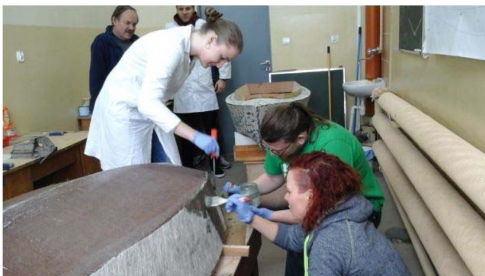
Rys. 15. Laminowanie kadłuba jachtu (nakładanie włókna szklanego i żywicy).
