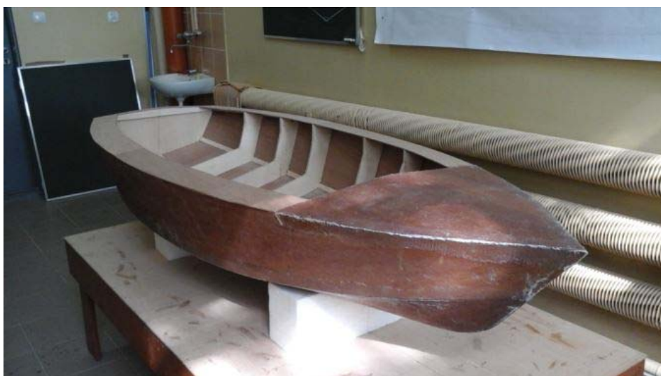
Rys. 16. Kadłub jachtu z zewnętrznym laminatem.
