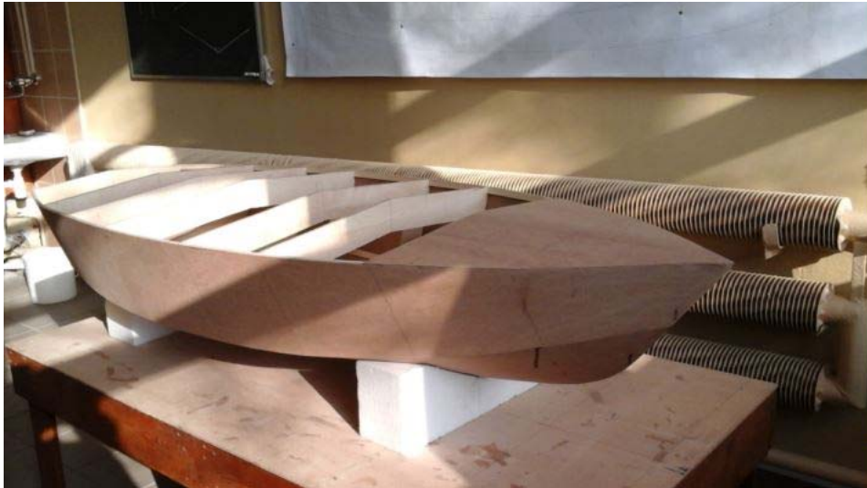
Rys. 11. Wykonanie pokładu ze sklejki.
