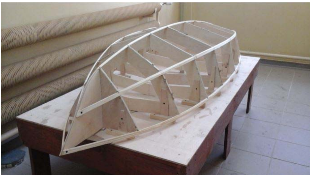
Rys. 6. Gotowy szkielet kadłuba jachtu.
