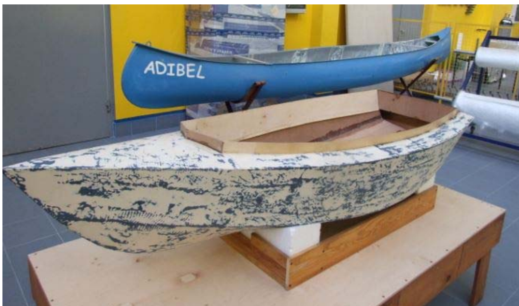
Rys. 20. Wyszlifowany i przygotowany do malowania kadłub jachtu.
