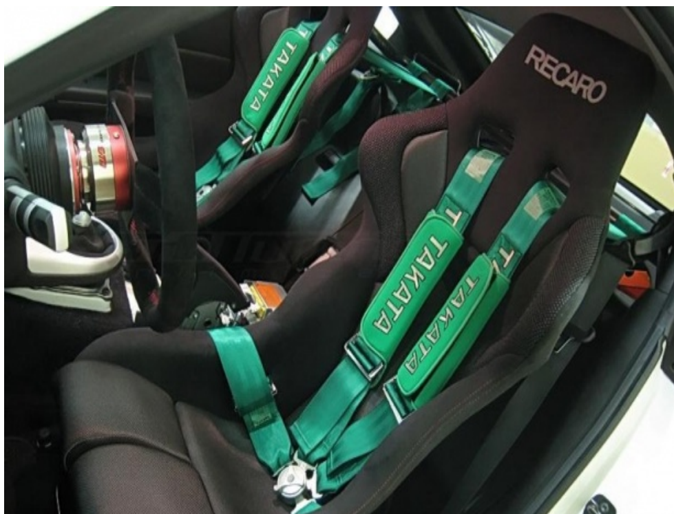
Rys. 5. Czteropunktowy pas bezpieczeństwa [10].
