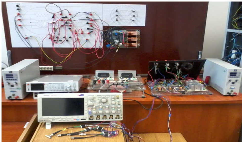
Rys. 3. Widok stanowiska do wyznaczania charakterystyk częstotliwościowych maszyn elektrycznych metodą SSFR.
