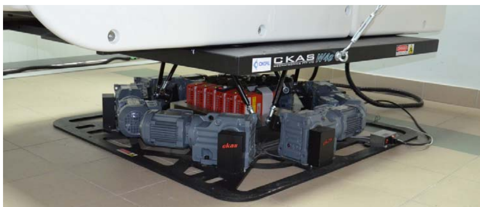
Rys. 2. Platforma ruchu o 6 stopniach swobody CKAS® wykorzystana w symulatorze OKTAL®.
